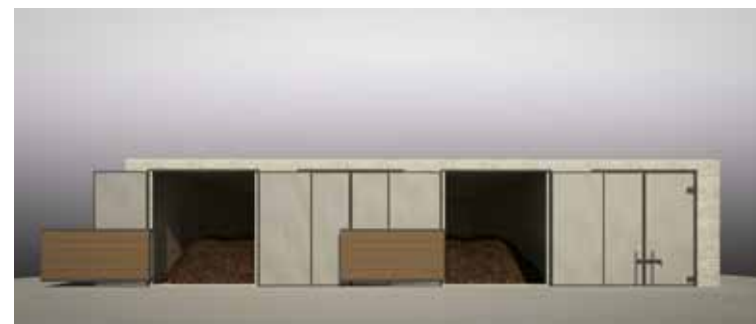
Vista frontale biocelle con porte e paratie di contenimento aperte.
